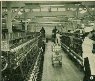
撚糸工場の一部 この撚糸機は六四台（13560 鐘）糸機機15台、合糸機11台。工場内は摂氏廿七度が一年中保たれ、整然として清潔の上ない。
