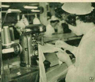
シーム・ミシン。編成された靴下を袋形に縫う、いわば皮型ミシンで、ここではじめて靴下らしくなる。米国シランガーミンで一台50-60万円のもの。
